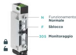
Il sistema DST (**Dorcas Sliding Technology**) garantisce l'apertura meccanica, sia in posizione normale che invertita, con un precarico fino a 20 kg. Per una maggiore sicurezza, l'incontro elettrico è dotato di un sistema secondario che assicura il blocco se l'apertura non è autorizzata elettricamente.
